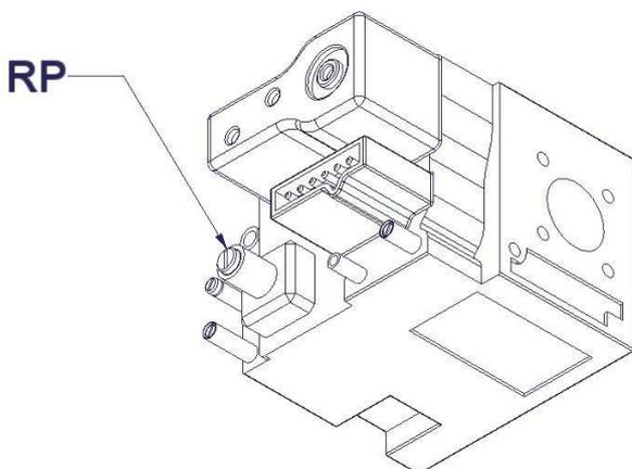
Para el funcionamiento con gas propano G31 y butano G30 el órgano de regulación de la presión del gas de la electroválvula debe ser excluido. De esta manera el caudal del combustible y consecuentemente la potencia térmica del aparato depende únicamente de la presión de la alimentación y diámetro de los inyectores instalados.
