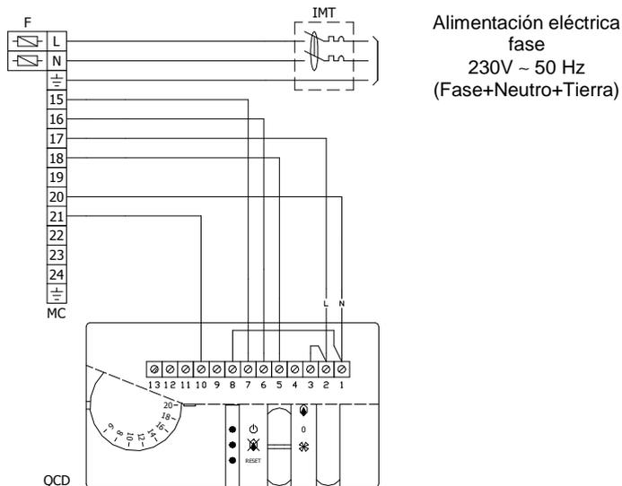
Conexión eléctrica cuadro de mando a distancia con termostato de dos etapas y reloj programador (accesorio a pedido)
