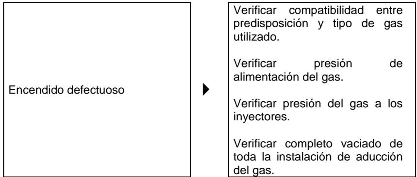
**Explosiones en fase de encendido del quemador.**
