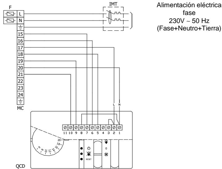
Conexión eléctrica cuadro de mando a distancia con termostato de una etapa y reloj programador (accesorio a pedido)
