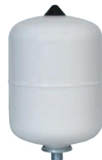
Los vasos de la **serie SMF / SMR** están destinados a ser usados en circuitos atmosféricos cerrados con agua no corrosiva en instalaciones solares. Se recomienda colocar el vaso de expansión en el retorno de la instalación solar, lo más alejado posible de los captadores.
